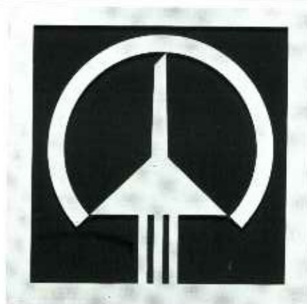
Aluminiumblech ausgeschnitten und in schwarze Grundplatte eingelegt. Eignet sich gut für Türgriffe.
